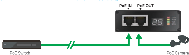
[ITS-100テスターをLANケーブルのPoE (PD) カメラ側に接続]
