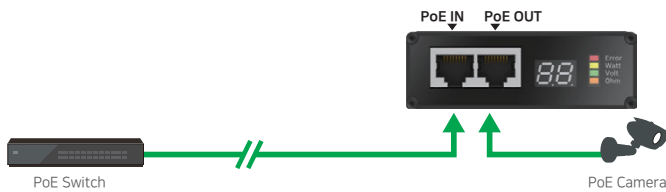
[TS-100을 LAN 케이블 종단 PoE(PD) 카메라 부위에서 사용하는 방법]
