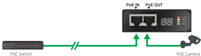
[ITS-100をLANケーブル終端PoE(PD)カメラ部位で使用する方法]
